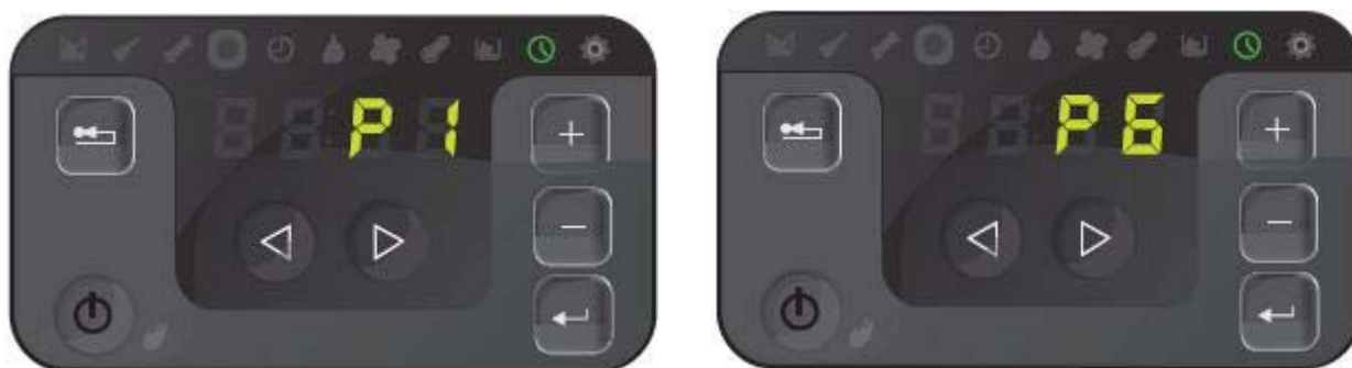
Slika 29: Prikazuje vremena za programirani rad kotla
